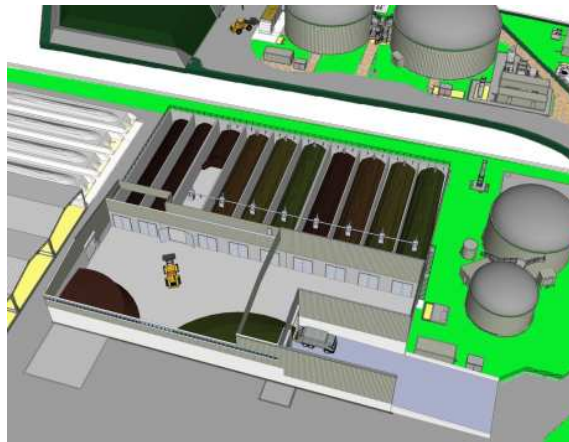
Abb. 1: Blick in die Anmischhalle mit Fermentern
